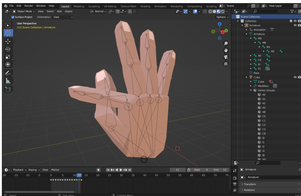
Fig. 3.9. – Modelo 3D de la mano, mostrando el esqueleto o “rigging” en la configuración de “T” del alfabeto dactilológico de la LSE. Se muestra el modelo mediante una captura de pantalla de Blender, la aplicación utilizada para su elaboración.
